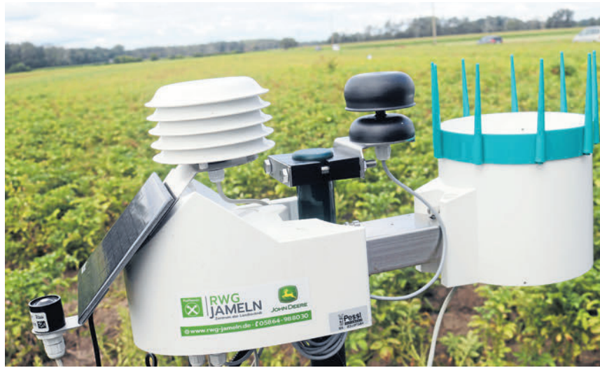
Diese Wetterstation kann viel mehr als nur die Temperatur und die Windgeschwindigkeit messen: Sie erfasst umfangreiche Klimadaten und soll erst einmal vor allem die Feldberegnung effizienter machen. Aufn.: R. Groß
